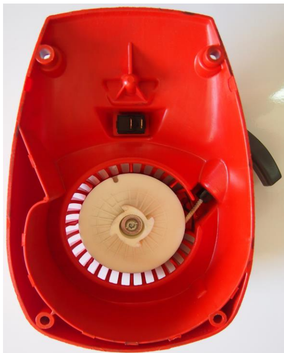
Фотография боковой крышки (с ручным стартером) с внутренней стороны
