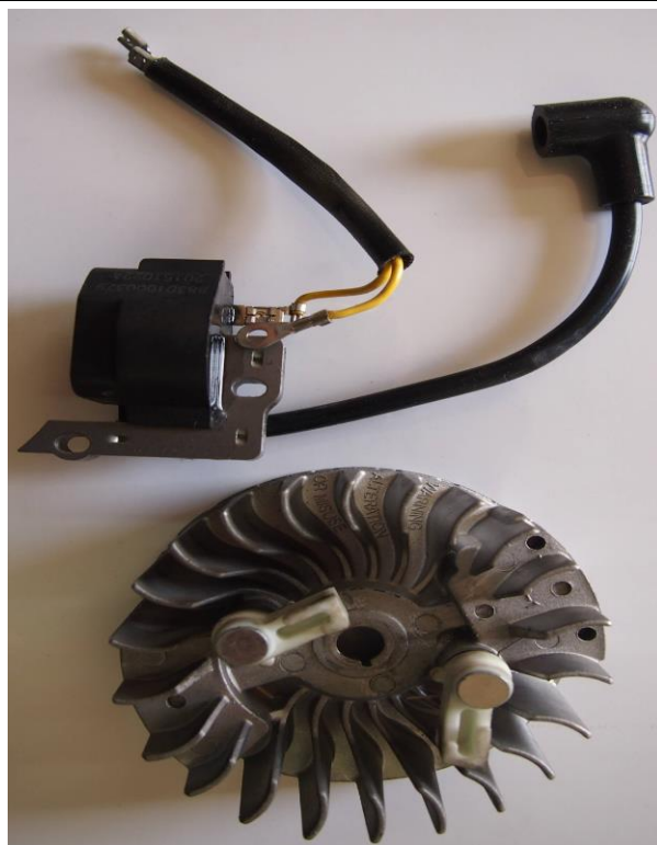
Фотография системы зажигания с лицевой стороны
